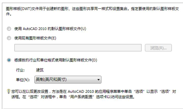
图形样板通常特定于工程或企业，以确保图形之间样式和设置一致。建议用户使用符合所在企业的 CAD 标准的图形样板。
